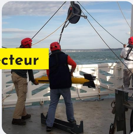
Mise en place d'un outil de mesures : le sonar.
